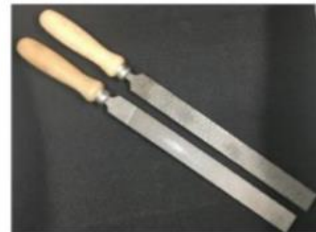
Fertigung der Fase mit Raspel (grob) und Feile (fein)
