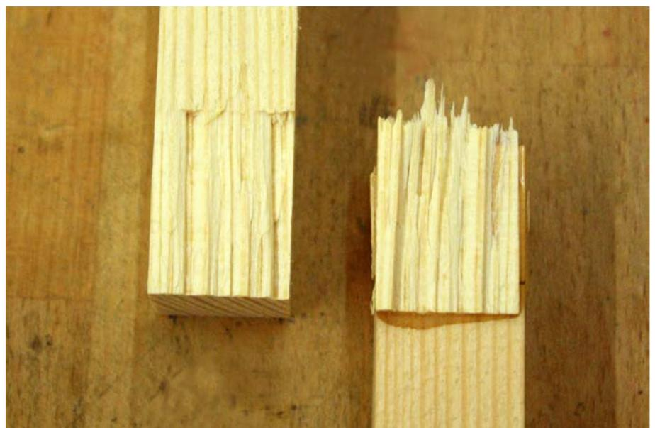
Abbildung 7: Bruchstelle der geleimten Verbindung.
