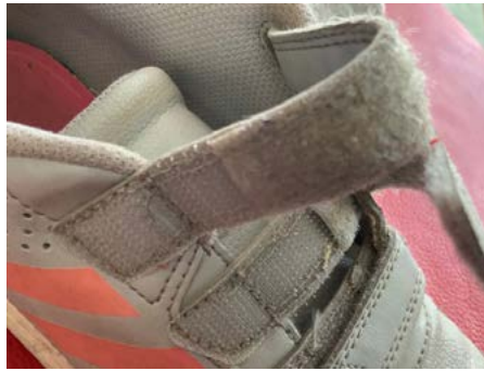
Abbildung 4: Der ursprüngliche Klettverschluss mit unterschiedlicher Ober- und Unterseite und die Weiterentwicklung mit zwei identischen Verbindungsteilen.
