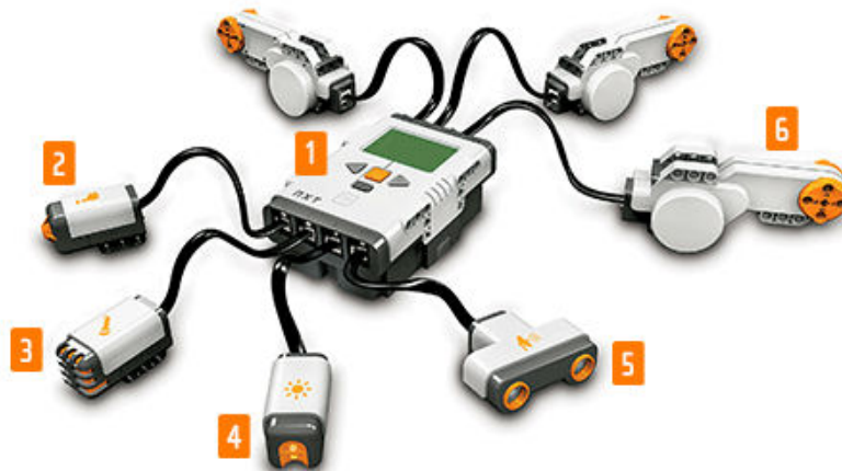
Abb. 5: NXT-Baustein mit Sensoren und 3 Motoren
