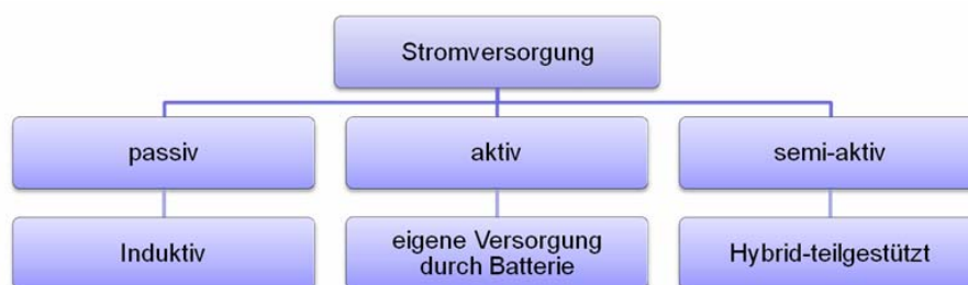
Abb. 2: Stromversorgung für Transponder
