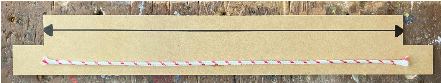
Hilfsmittel, um die Seillänge von 600mm ohne Messgeräte zu bestimmen.
