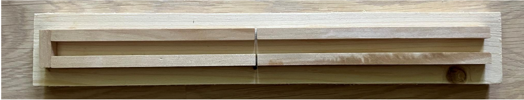
Eigene Schneidlade, um ein 30cm Rundholz in 14 bzw. 16cm zu zersägen.
