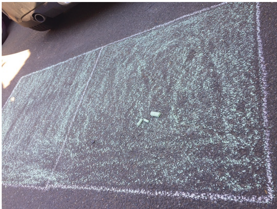
Abb. 12 Testergebnis: Ein gängiger Zylinder an Straßenmalkreide reicht etwa für eine Fläche von 1,5\text{ m}^2 . (©Xenia- Rosemarie Reit 2021)
