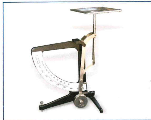
3 Eine Zeigerwaage misst die Auslenkung eines Gewichts an einem Hebelarm
