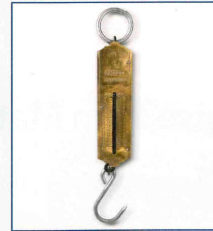
6 Bei der einfachen Federwaage wird die Verlängerung einer Feder gemessen
