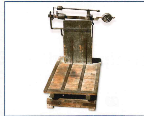
4 Laufgewichtswaagen basieren auf dem Hebelgesetz: Durch Verschieben eines Gewichts ...
