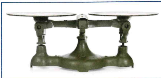
2 Bei der Tafelwaage befinden sich die Waagschalen oberhalb des Waagbalkens
