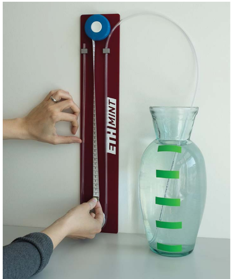
Abb. 5: Die Lernenden untersuchen den Wasserdruck für verschieden geformte Vasen mit einem U-Rohr-Manometer.
