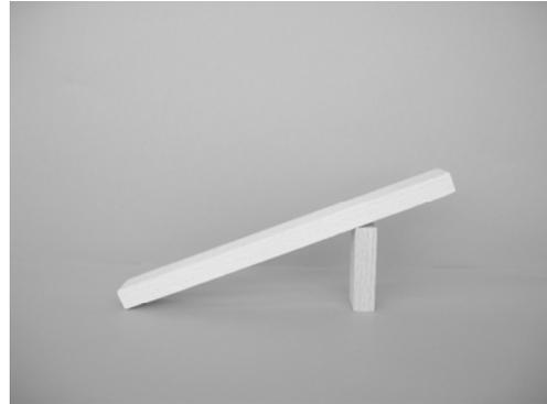
Entsprechend kann daraus abgeleitet werden, dass bei einem zweiarmigen Hebel kein Gleichgewicht herrscht, wenn die beiden Drehmomente  $M_1$  und  $M_2$  unterschiedlich groß sind. Dieser Fall würde z. B. eintreten wenn, wie auf der Wippe auf dem rechten Foto abgebildet,  $F_1 * 2a_1 > F_2 * a_2$  und daher  $M_1 > M_2$  wäre.
