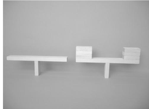
Verdeutlicht werden kann das Phänomen des Gleichgewichts auch durch das Hebelgesetz für den zweiarmigen Hebel, das besagt: Ein Gleichgewicht liegt vor, wenn  $\mathbf{M}_1 = \mathbf{M}_2$ . Das heißt, das Produkt aus Kraft und Hebelarm ist auf beiden Seiten gleich.<sup>9</sup> Auf dem rechten Foto ist ein zweiarmiger Hebel zu sehen, der auf einem Drehpunkt aufliegt. Werden auf beiden Seiten gleich viele Holzbausteine in gleichem Abstand zur Drehachse aufgelegt, so herrscht ein Gleichgewicht.
