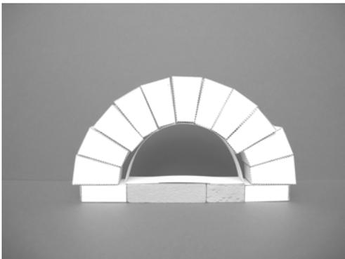
Bevor der Bogen fertig gestellt und der oberste Papierkeilstein (Schlussstein) eingesetzt wird, sollen die SchülerInnen beobachten was mit den unteren Papierkeilsteinen in dem Augenblick passiert, in dem der oberste Papierkeilstein eingefügt wird. Wenn die Kinder die Beobachtung äußern, dass diese nach außen rutschen, kann an den Versuch mit dem
