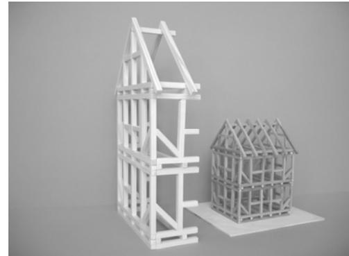
Der linke Modellausschnitt ist aus Holzvierkanteleisten (10 mm \* 10 mm), das rechte Modell aus Holzvierkanteleisten (5 mm \* 5 mm) erstellt.
