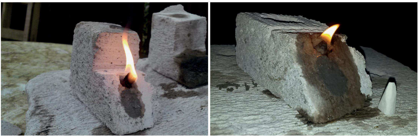
Abb. 3: Öllampe links mit und rechts ohne brennbaren Docht
