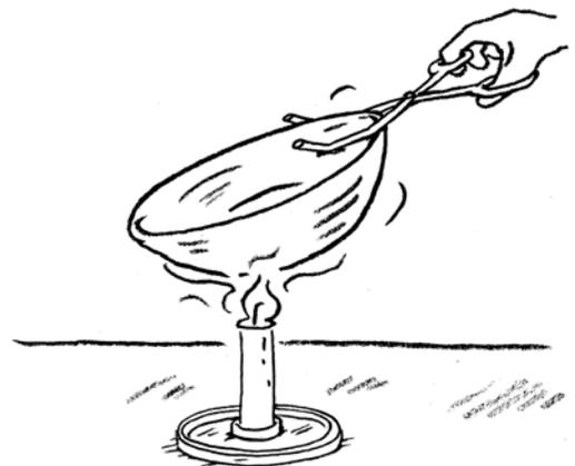
5. Halte das Becherglas einige Sekunden über die Kerzenflamme (aber nicht vollständig, sonst geht die Flamme aus!). Was entdeckst du im abgekühlten Becherglas?
