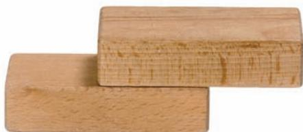
**Abb. 1:** Der obere Stein ist nach rechts vorgekragt. Sein Schwerpunkt liegt auf der Auflagefläche des unteren Steins.
