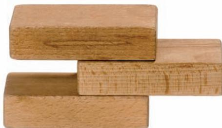
**Abb. 3:** Mit einem Gegengewicht – oberster Stein – wird der vorgekragte Stein in seiner Position gehalten.
