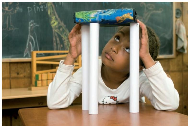
**Abb. 2:** Geschlossene Profilformen wie z. B. Röhren erwiesen sich als weit stabiler als offene Varianten.
